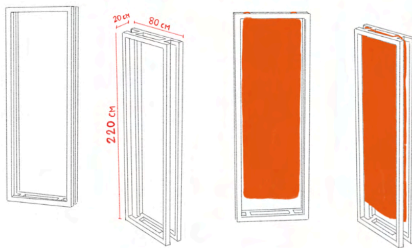
Figura 49 - Desenho da estrutura para bandeira isolada e com bandeira (em laranja) aplicada.
